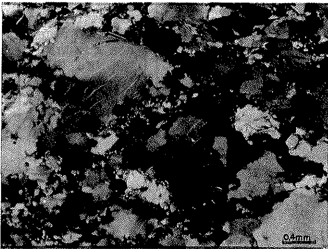
Fotomicrografia 2 — Amostra 140. Charnockito cataclástico. Porfiroclastos de feldspato potássico pertítico e plagioclásio. Recristalização incipiente da matriz. Nicóis cruzados
